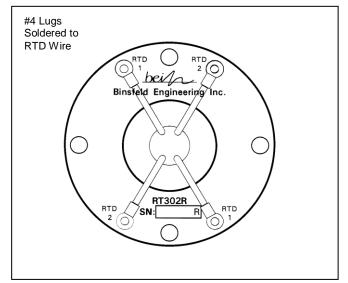
Rotor-RTD Wiring Diagram
