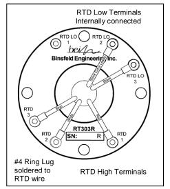
Rotor-RTD Wiring Diagram
