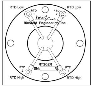
Rotor-RTD Wiring Diagram
